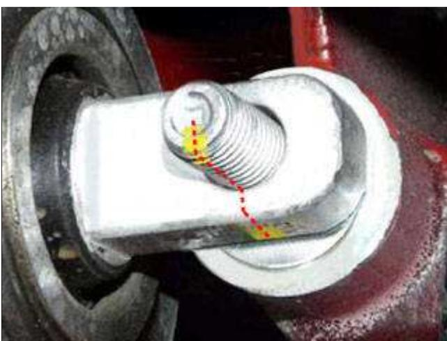
● 再次检查并确认黄色参考标记已正确对齐：双头螺栓上的标记和衬套 (flanbloc) 有眼螺栓上的标记必须对齐。
