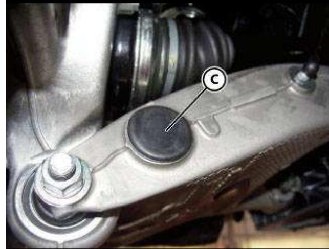
● 用手将橡胶塞 (C) 按压到下臂前部相应座内。
