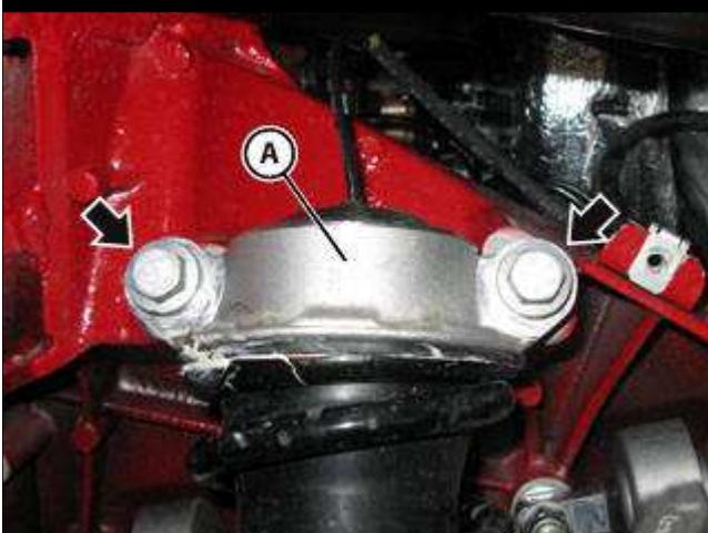
● 松开指示的将减震器 (A) 紧固至底盘的两个螺钉。
